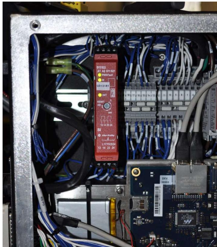
FIGURE 7-4. SAFETY RELAY-CONFIGURATION
