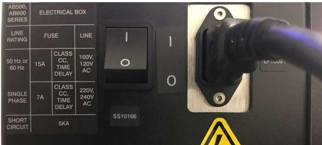
FIGURE 3-9. MAIN E-BOX POWER SWITCH
